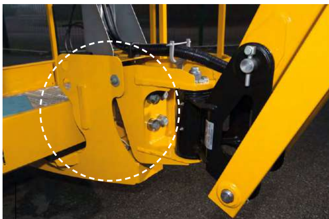
SISTEMA DE PESAJE PROTEGIDO por la pieza de unión
