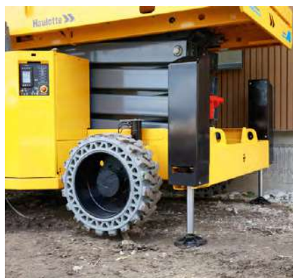
Capós reforzados para garantizar la protección de los estabilizadores
