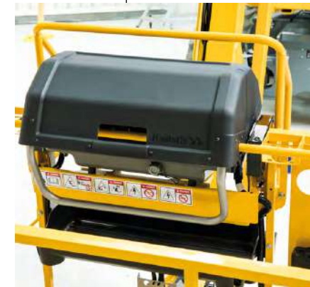
Control de mandos protegido por una cubierta de materiales compuestos de alta resistencia
