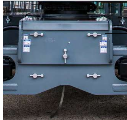
Cilindros de dirección protegidos dentro del chasis
