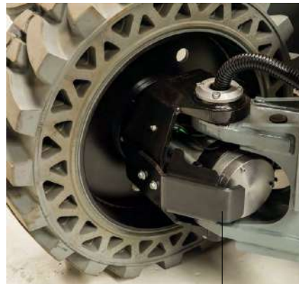
Gruesas cubiertas protectoras de los motores de tracción
