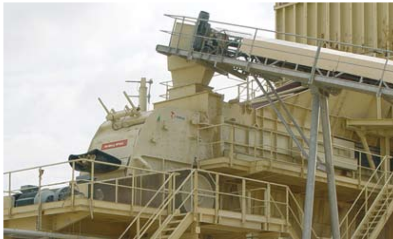
Aplicación secundaria : molinos de impacto NP1620 en instalación fija.
