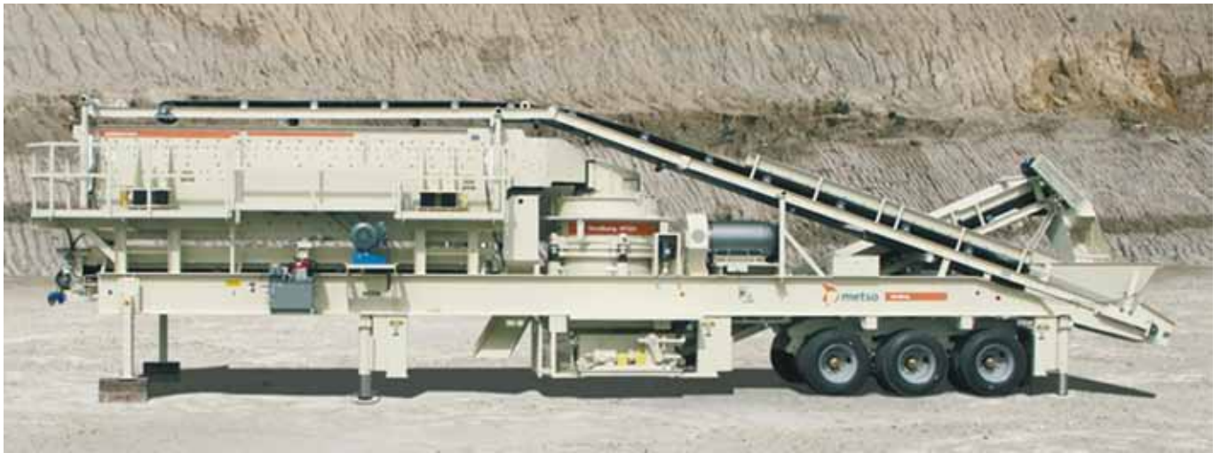
Aplicación móvil : Molino de cono HP300 en versión grupo móvil.
